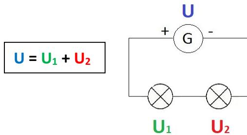
Lorsque le **nombre** de dipôles **augmente**, la tension aux bornes du dipôle **générateur** ne **change pas** et la tension aux bornes des dipôles **récepteurs** **diminue**.
