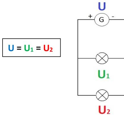
Lorsque le **nombre** de dipôles **augmente**, la tension aux bornes des dipôles **ne change pas**.
