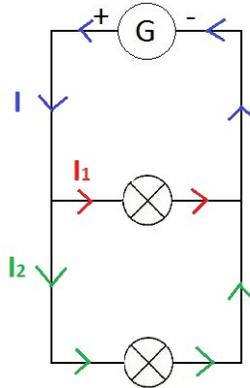
Lorsqu'on ajoute des dipôles montés en dérivation, on augmente l'intensité du courant dans la branche principale. Elle peut alors s'échauffer et provoquer un incendie.
