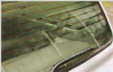
Fils de désembuage sur vitre arrière d'une voiture
